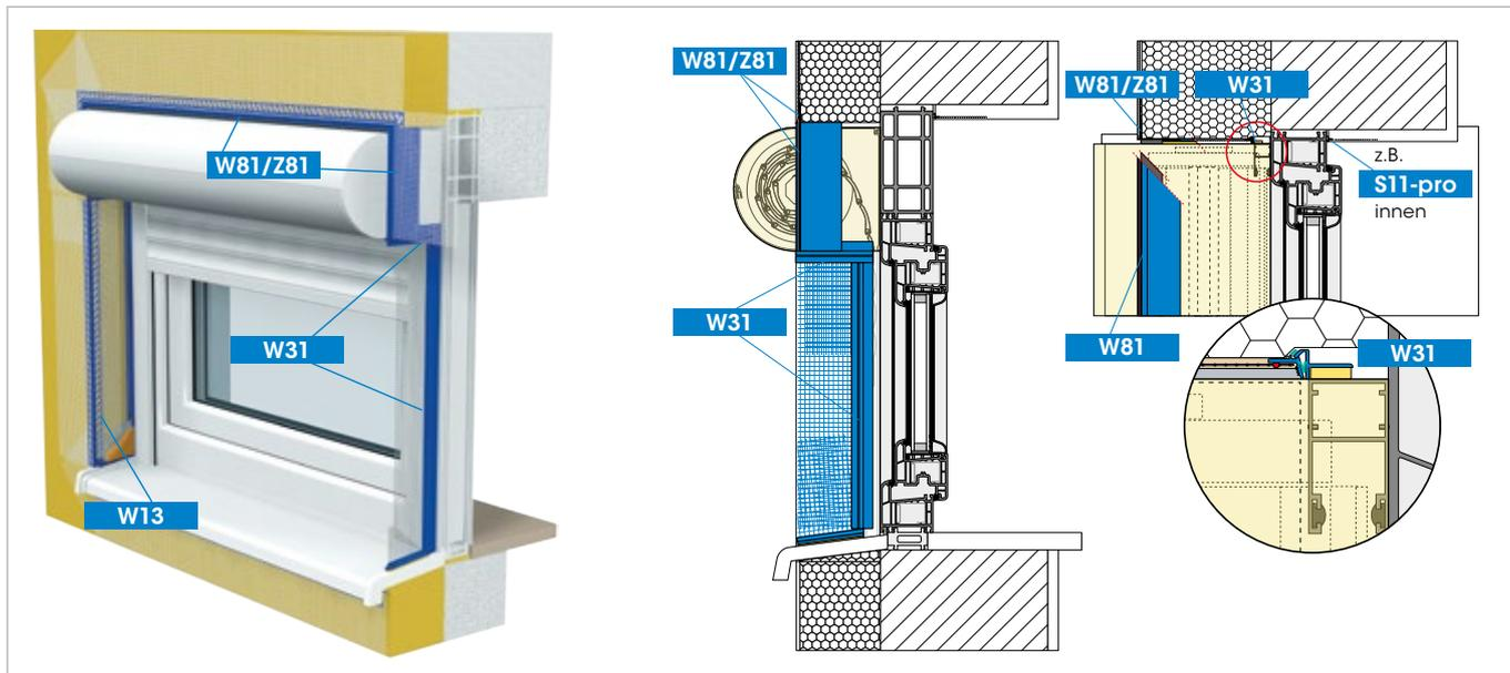
Fachgerechter Anschluss durch umlaufende Abdichtung mit den Profilen W31 und W81/Z81, ergänzend mit Gewebebeckwinkel W13.
